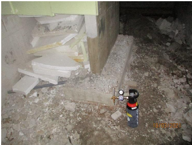
Bild 58. Spårgas sattes in i krypgrunden.
