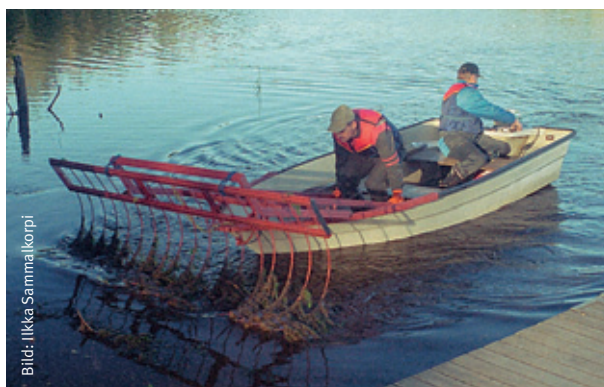
▲ För att ta bort undervattensväxter nära stranden kan man använda långa räfsor eller frontmonterade anordningar på båten.
