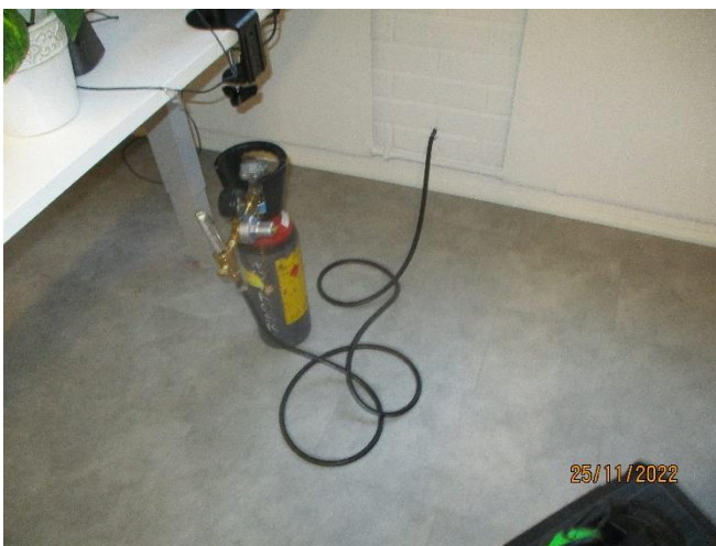
Bild 6. Spårgasen matades in i ytterväggens nedre kant med 6 liter per minut.
