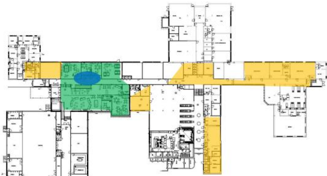
Kuva 3. 1. kerroksen betonialapohja-alueen mikrobivaurioituneet alueet (keltaisella). Vihreällä on merkitty vuonna 2017 korjattu alue ja sinisellä kosteuspoikkeama-alue.
