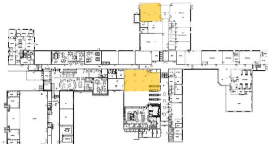
Kuva 2. 1. kerroksen puulattioiden alueilla arvioidut mikrobivaurioituneet alueet.
