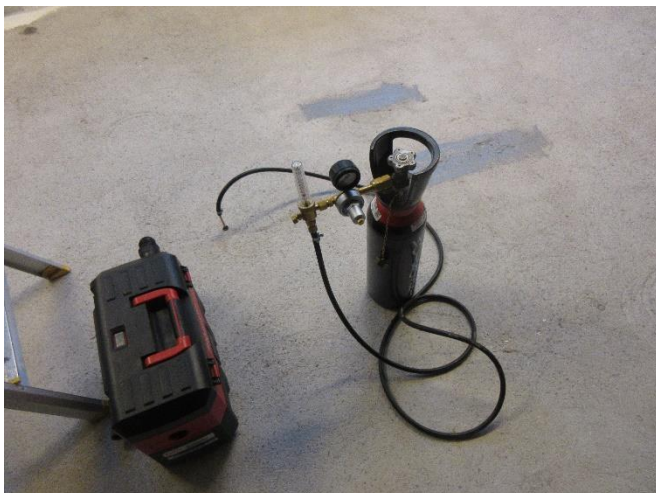
Bild 71. Spårgas matades in i isoleringsskikten och man undersökte om det kunde läcka in någonstans.
