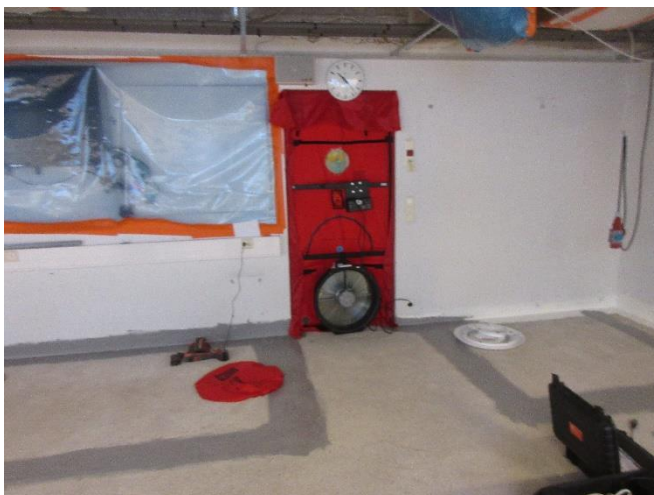
Bild 70. Vid spårgasmätning sattes utrymmet i 10Pa undertryck i jämförelse med isoleringsskiktet.
