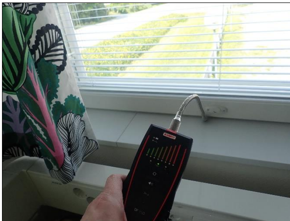
Merkkiainekoe ME.03-US, Luokka 2008, ei havaittu ilmavuotoja
