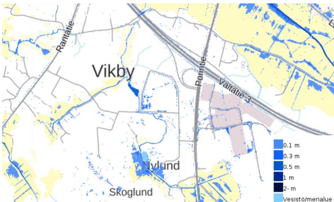
Bild 9. Utdrag av Översvämningscentrets karttjänst - översiktlig dagvattenöversvämningskarta 2024. Kartan åskådliggör vattendjupet vid ett 52 mm regn under en timmes tid.
