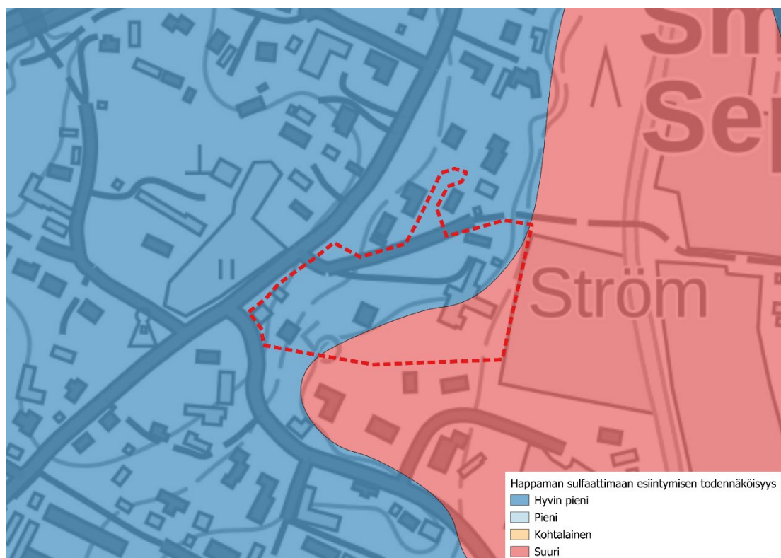
Bild 10. Karta som visa sannolikheten för förekomst av sura sulfatjordar i området. (Kartmaterial som visar sannolikheten för förekomst av sura sulfatjordar: Geologiska forskningscentralen, terrängkarta: Lantmäteriverket)
